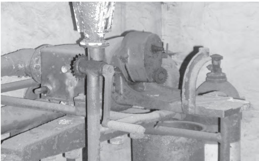
*Immagine n.17 - La manovella che avrebbe permesso il funzionamento manuale dell'apparecchiatura. La catena di distribuzione è stata rimossa, lo stesso dicasi per il motore elettrico, del quale è possibile notare il suo alloggiamento e la staffa di fissaggio.*
