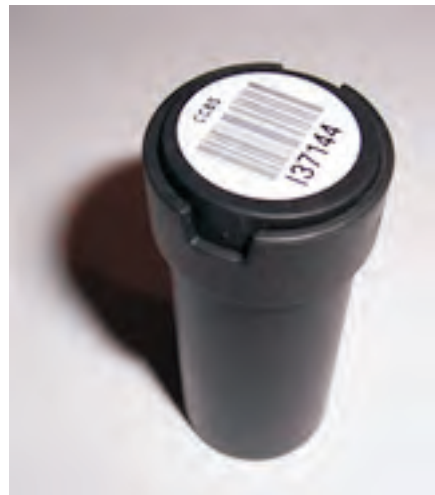
Rivelatore passivo modello RSKS tipo CR/39/PADC
